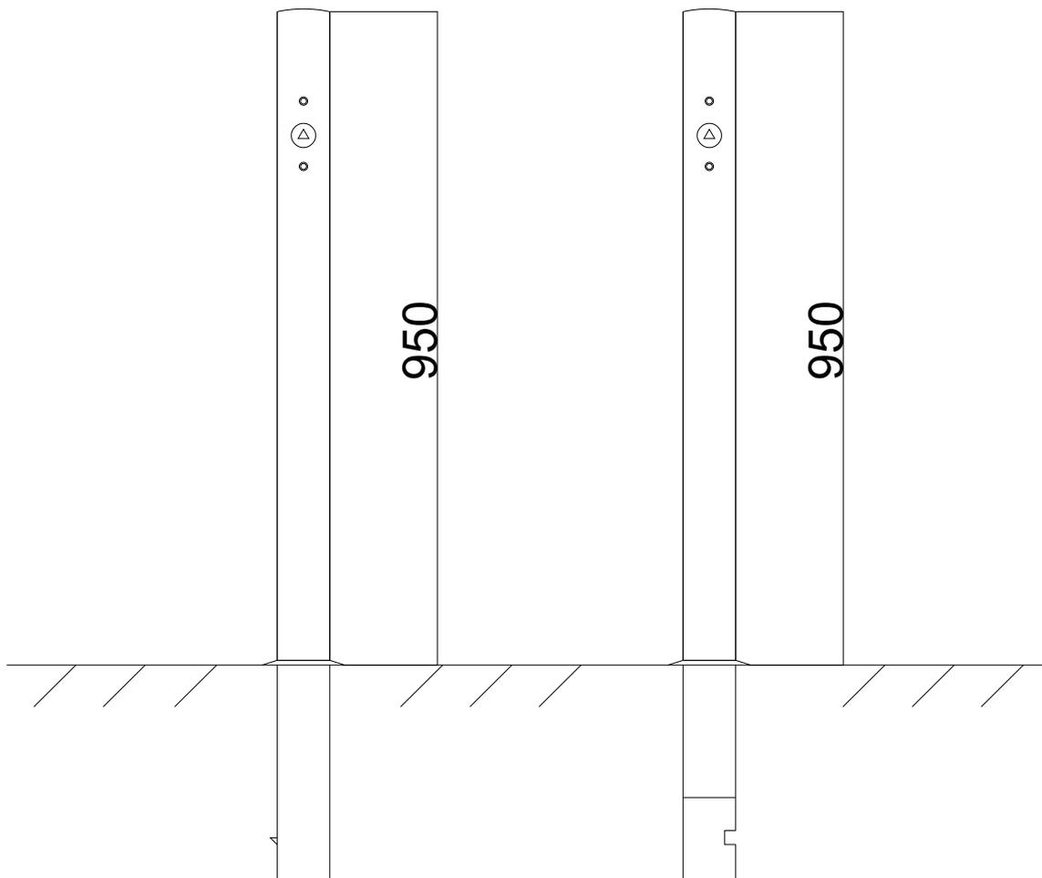
Ausführung: Rundrohr Ø 70 / 76 / 102 mm
