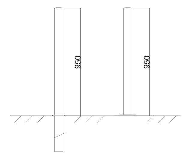
Ausführung: Rundrohr Ø 70 / 76 / 102 mm
