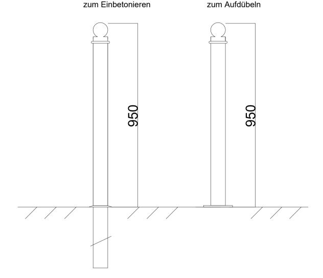
Ausführung: Rundrohr Ø 70 mm Material: Stahl feuerverzinkt
